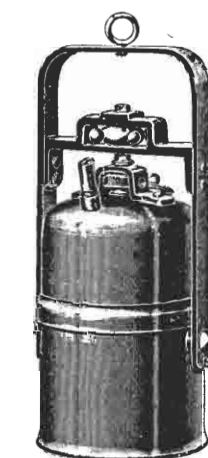
Lampes T à étrier à pointeau central pour le réglage de l'eau. Caractéristiques communes
